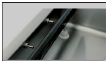
Part. unità iniezione gas inerte
