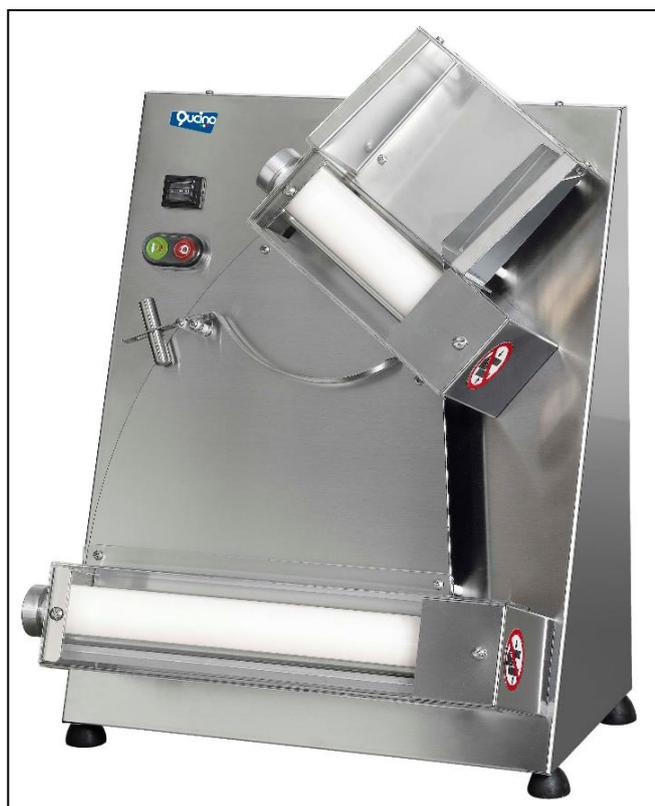
• Stendipizza-sfogliatrice da banco a rulli verticali inclinati, ideale per pizze, pane, focacce, piadine, ecc. fino diam. cm. 40 • Lavorazione con laminatura a freddo, adatta per non alterare le caratteristiche della pasta • Struttura in acciaio inox • Spessore regolabile fino a 5 mm. e dotato di scheda di sicurezza come da normativa CE • Pulsante per funzionamento in continuo e comandi a pedale di serie • Pignone con ingranaggi inox e trasmissione diretta al motore.
