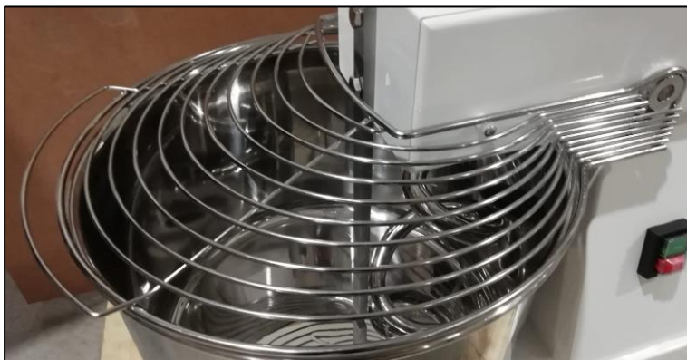
Part. griglia di protezione mobile inox
