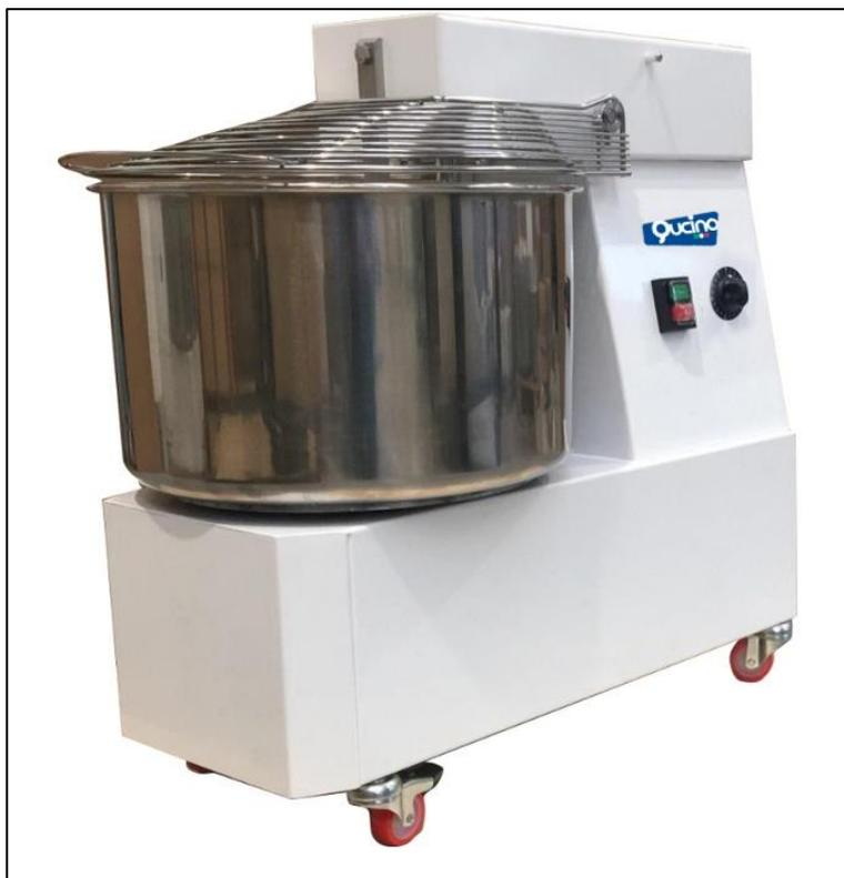
• Impastatrice a spirale trifase adatta a qualsiasi tipo di impasto, costruita in acciaio inox ad alto rendimento e verniciato bianco • Sistema di trasmissione particolarmente silenzioso grazie ad un tensionatore per la catena e motoriduttore a bagno d'olio • Vasca, coperchio, spirale e spaccapasta in acciaio inox AISI 304 • Timer, kit ruote e piedini in dotazione, per posizionamento su banco o a terra • Capacità impasto totale: fino a Kg. 17
