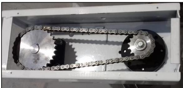
Part. trasmissione con ingranaggi a catena per utensile a spirale
