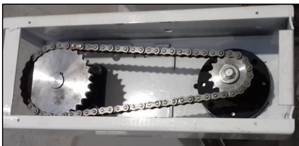
Part. trasmissione con ingranaggi a catena per utensile a spirale
