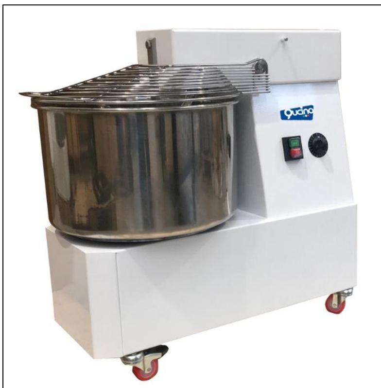
• Impastatrice a spirale trifase adatta a qualsiasi tipo di impasto, costruita in acciaio inox ad alto rendimento e verniciato bianco • Sistema di trasmissione particolarmente silenzioso grazie ad un tensionatore per la catena e motoriduttore a bagno d'olio • Vasca, coperchio, spirale e spaccapasta in acciaio inox AISI 304 • Timer, kit ruote e piedini in dotazione, per posizionamento su banco o a terra • Capacità impasto totale: fino a Kg. 25
