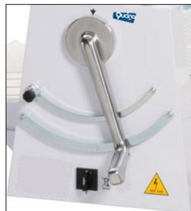
Part. regolazione manuale spessore dei cilindri
