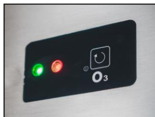
Part. comando attivazione generatore di ozono
