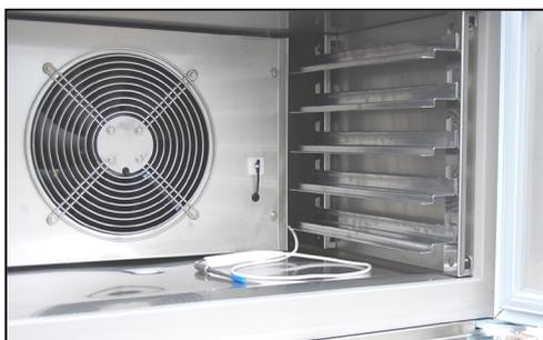
Part. interno con sonda a spillone inox
