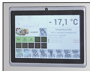
Part. pannello comandi touch screen evoluto ed intuitivo per seguire ogni passaggio e gestione operativa o in teleassistenza da remoto
