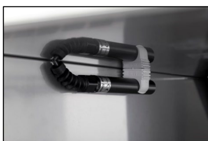
Part. sonda per controllo umidità
